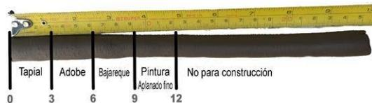
Figura 6. Aplicación de la tierra según el corte del chorro.
