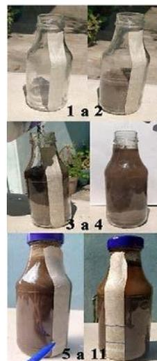
Figura 4. Prueba de botella, proceso de prueba de sedimentación. Fuente: Elaboración propia.
