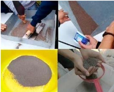
Figura 2. Tamizado para obtener la tierra para pruebas. Sedimentación o prueba de botella. Fuente: Elaboración propia.
