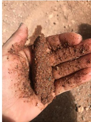
Figura 24. Prueba de adherencia de la tierra. Fuente: Elaboración propia.
